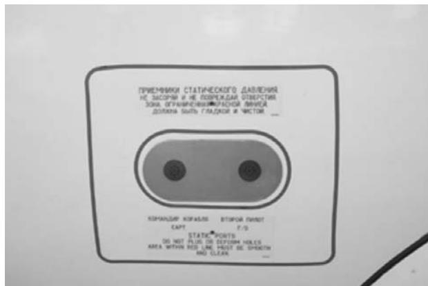
Рисунок 3 - Приемник статического давления
