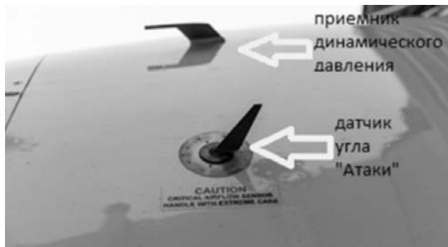
Рисунок 4 - Приемник динамического давления и датчик угла «Атаки»
