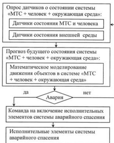
Рис. 1. Общая схема принятия решений в системе аварийного спасения
