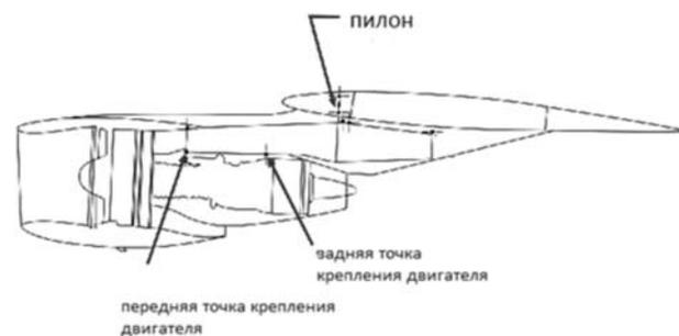
Рисунок 7 - Пилон, двигатель и точки крепления двигателя к пилону
