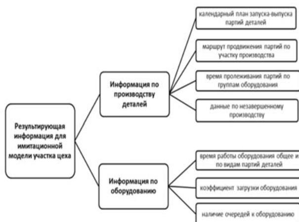
Рис. 2. Выходная информация для формирования имитационной модели
